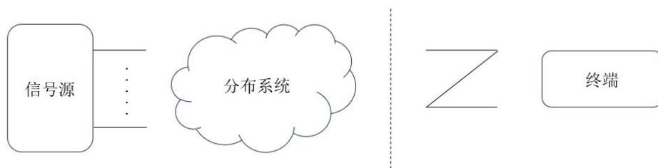
图 1 无线室内覆盖系统示意图
